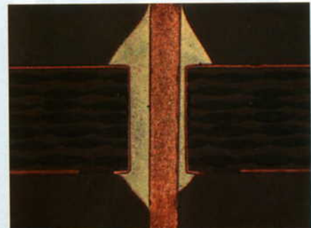
写真3 挿入部品の断面(日本製薬機器株提供)
