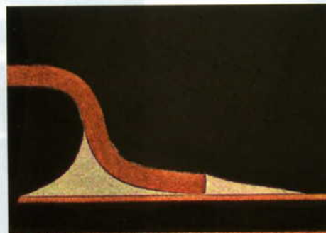
写真2 QFPリードの断面(日本製薬機器株提供)
